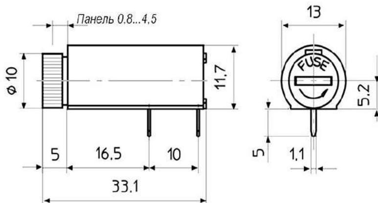
Тип предохранителя, мм
