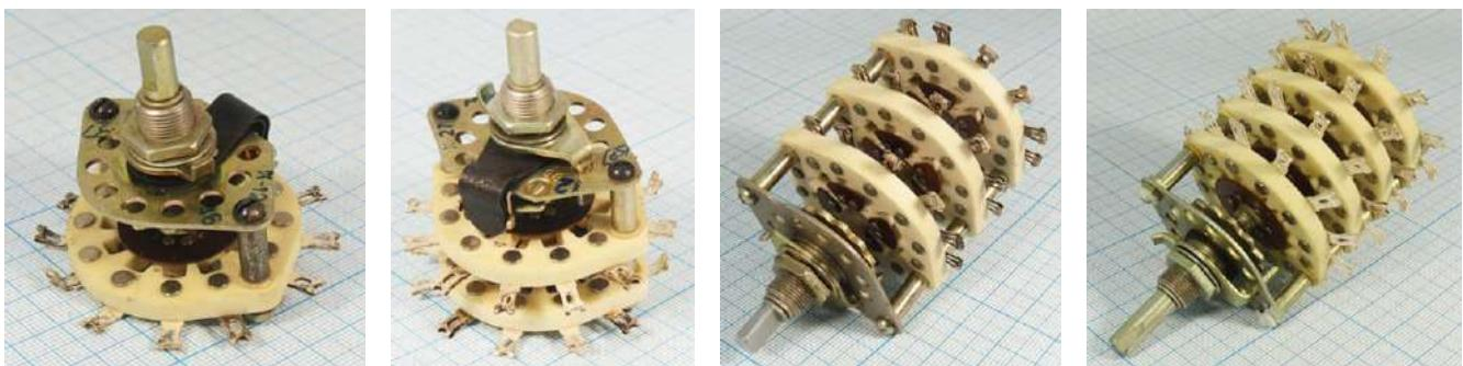
Переключатели ПГК – переключатели галетные керамические, их еще называют галетники, коммутируют цепи сигнализации и управления с напряжением до 350В, силой тока до 3А и коммутируемой мощностью до 70Вт. Переключатель обеспечивает поворотное переключение контактов, расположенных на галетах (платах) в количестве от 1-й до 4-х, в положениях от 2-х до 11-ти и в направлениях от 1-го до 16-ти. Способ крепления – фиксация в отверстии с помощью резьбы оси и гайки переключателя.
