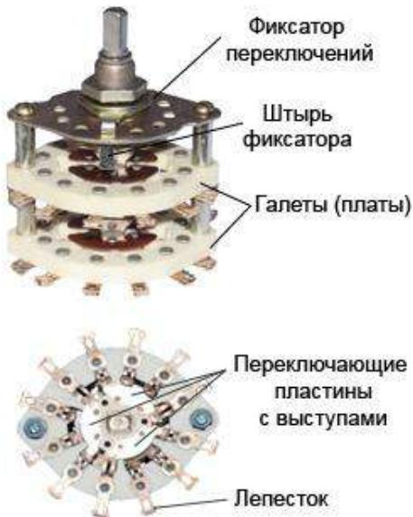
Устройство галетных переключателей ПГК: Переключатель галетный керамический ПГК состоит из фиксатора переключений и галет (плат). Фиксатор переключений закрепляет положения и ограничивает движение подвижной части переключателя. Штырь фиксатора переключений вставляется в отверстие, тем самым определяет число положений.
